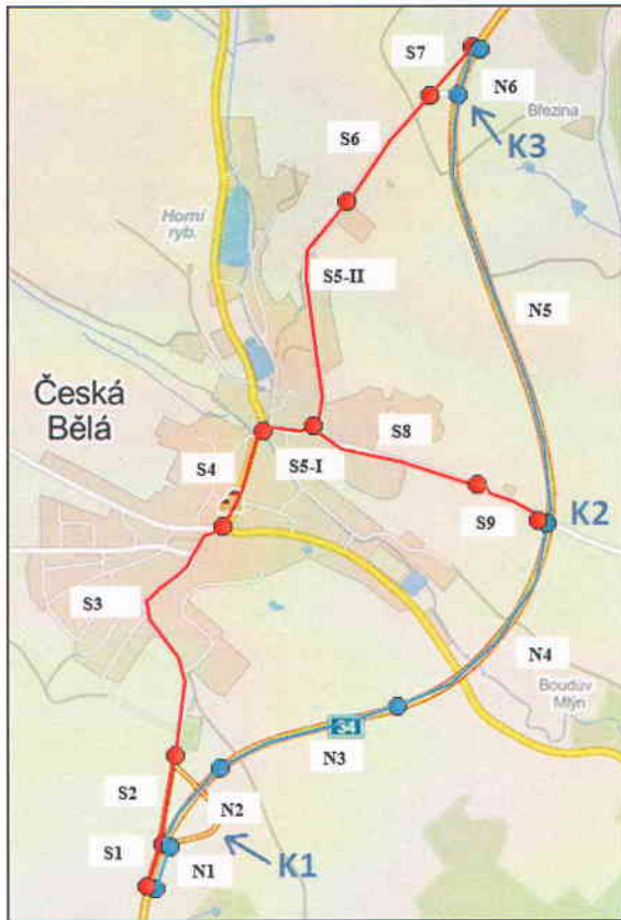
Obr. 3: Schéma příkladu hodnocení – obchvat obce Česká Bělá • vlevo průtah (úseky S1 až S7), další ovlivněná síť (úseky S8 a S9) • vpravo obchvat (úseky N1 až N6), křižovatka K1 (MÚK - větev, rampa, odpojný bod, přípojný bod), křižovatka K2 (průsečná), křižovatka K3 (styková)
